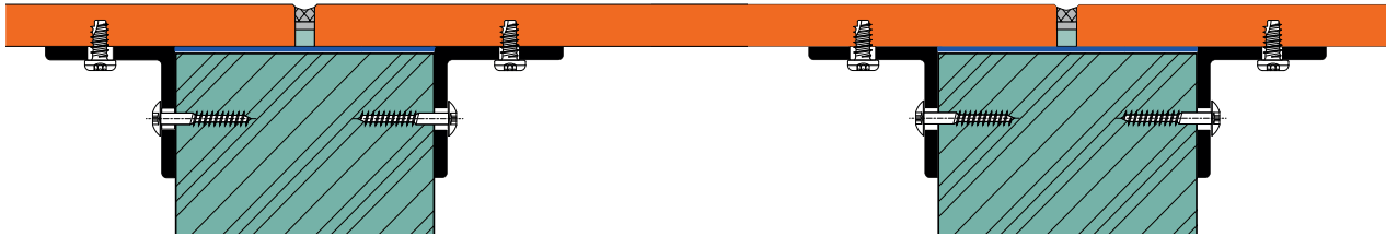
Balkonbodenplatte auf Holztram verdeckt befestigt (geschraubt)
